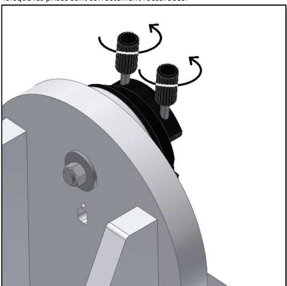
Figure 17. Desserrez les deux molettes de la queue d'aronde (pièce 1) afin de fixer la queue d'aronde du télescope sans aucun obstacle.
